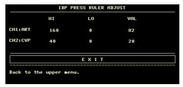
Figure Errore. L'origine riferimento non è stata trovata.-11 IBP SCALE ADJUST Menu
