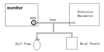
Figure Errore. L'origine riferimento non è stata trovata.-3 Diagram of NIBP Calibration
